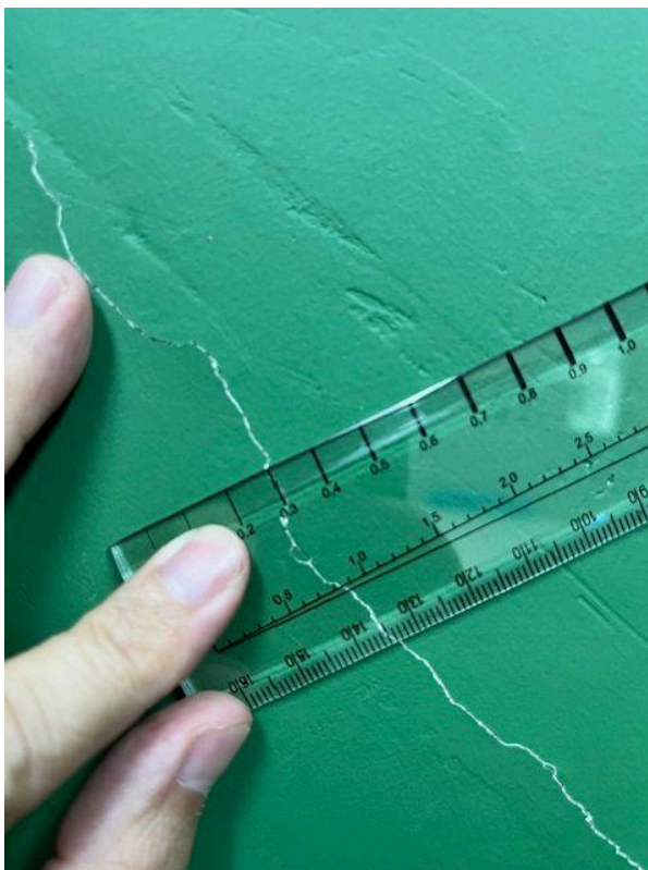
Fotografia 22. Marcação 2.11 - Medição com fissurômetro de fissura na parede da sala de estudos.
